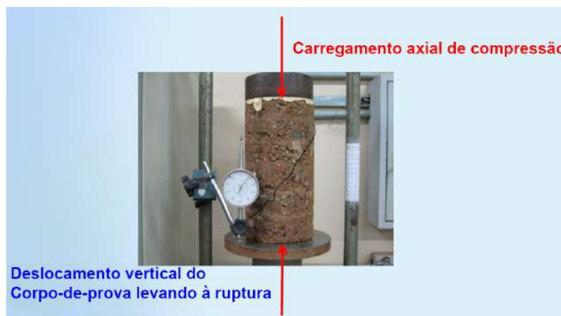
Figura 7 – Determinação da resistência de solos – Ensaio de Compressão Simples
